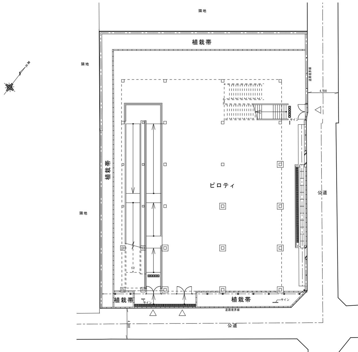
配置図、1階平面図 1/200
