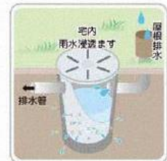
宅内雨水浸透ます
