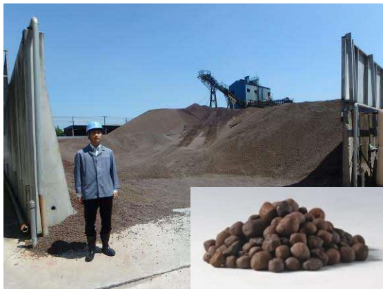
【焼却灰等の再資源化】 汚泥焼却灰の軽量骨材*化
