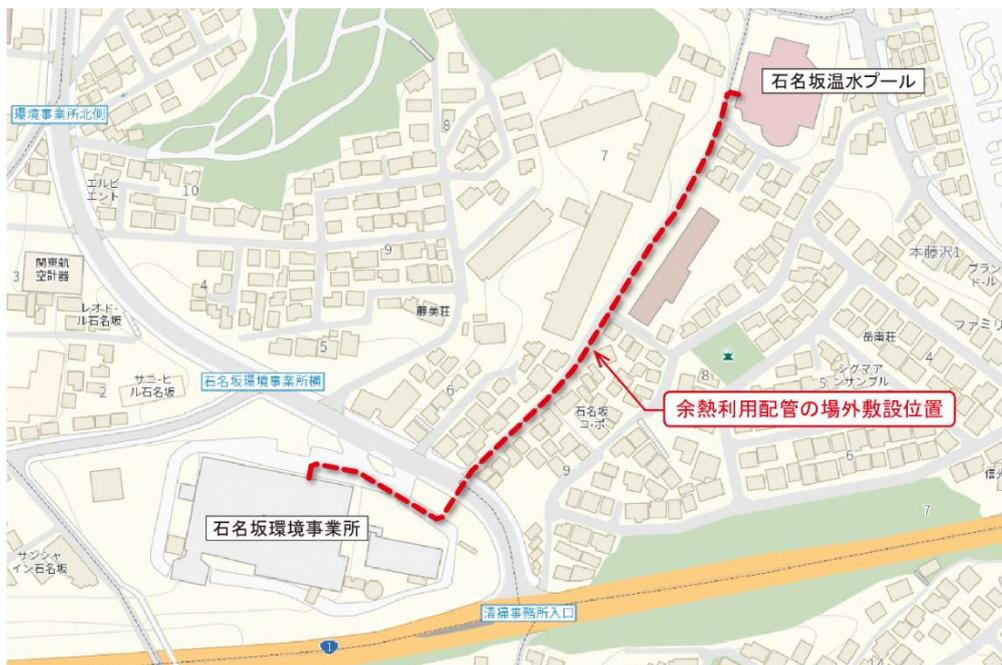
図 4-2 余熱利用配管の敷設位置図
